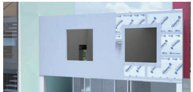
Figura 6.4: Capa base reforzada sobre la placa exterior Glasroc® X.
