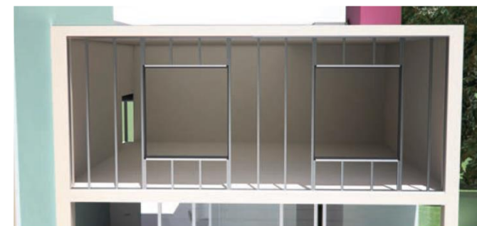
Figura 6.1: Subestructura auxiliar de huecos y exterior del sistema.
