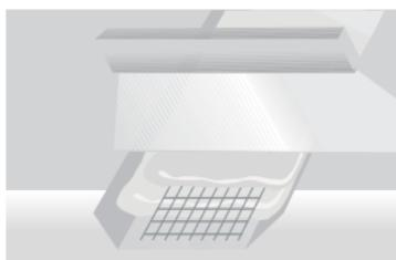
Posteriormente se rellena la junta con una última capa de pasta **Placo® PR Multi** y se coloca la cinta de malla.
