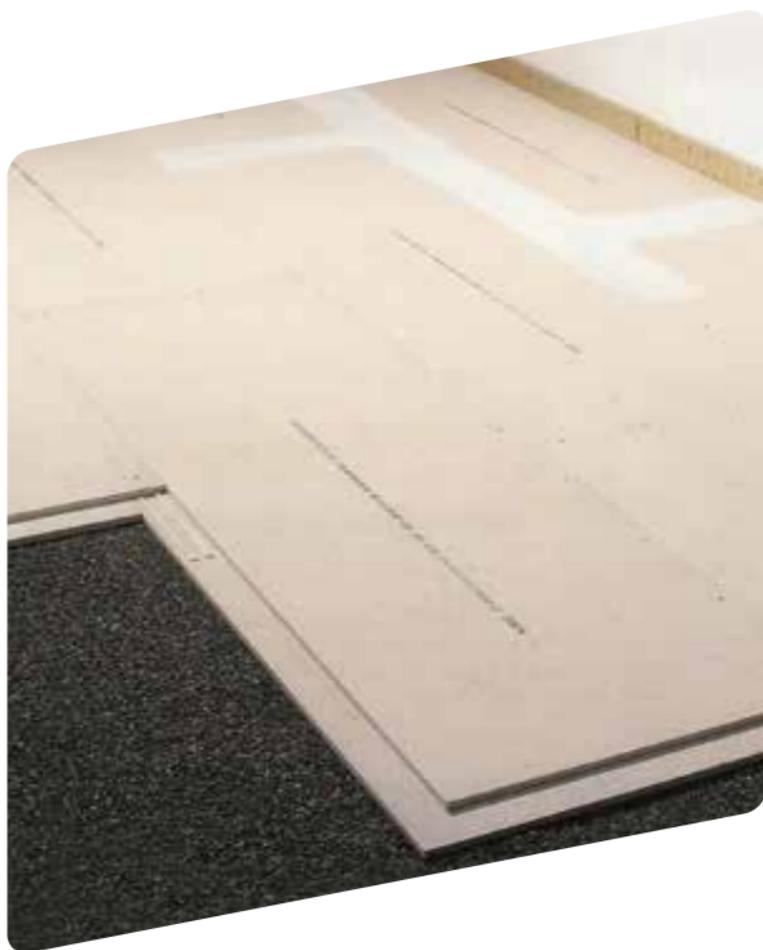
Presenta unas dimensiones reducidas de 1.500 mm x 500 mm, y un borde machihembrado tanto longitudinal como transversal de 50 mm de ancho, que permite una sencilla colocación y un correcto solape de las placas.
