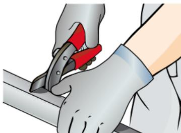
La unión mecánica de perfiles metálicos entre sí se realizará por medio de tornillos TRPF o punzándolos mediante grapadora especial.
