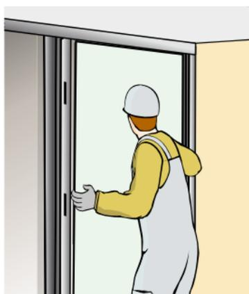
Para sujetar la placa **Coreboard**® insertaremos los perfiles de fijación uno en cada montante, entre éste y la placa.
