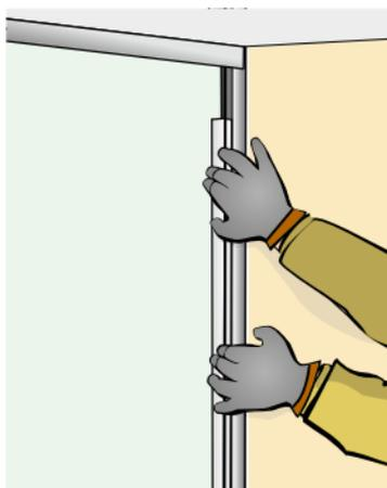
Refuerzo frente al fuego mediante la colocación de lametas. Para reforzar el aislamiento frente al fuego en la parte superior, insertar una pieza de la placa **Coreboard**® de 19 mm y otra de PPF 15 mm de espesor y 122 mm de ancho entre los montantes en "I".
