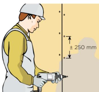
La sujeción de las placas a los montantes se realizará mediante una atornilladora eléctrica con reglaje de profundidad, para que una vez atornillada, la cabeza trompeta de los tornillos no rompa el cartón, quedando perpendicular ligeramente por debajo de la superficie de la placa.
