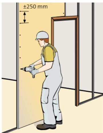
En caso de tabiques de dos o más placas por cada cara, la primera placa se fijará a la estructura mediante tornillos equidistantes como máximo 700 mm.
