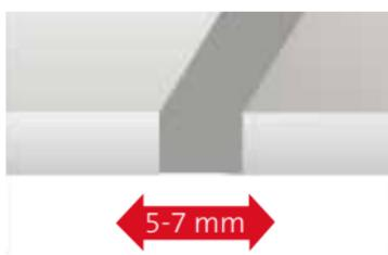
Antes de proceder al relleno de la junta aplicar una capa de Iberprimer en los cantos de las placas, a continuación rellenar completamente el interior de la junta con Pasta **Placo® PR Multi**, cerciorándose de que hace buen contacto con los laterales de la placa.
