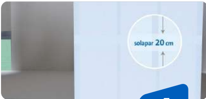
COLOCACIÓN LÁMINA IMPERMEABLE
