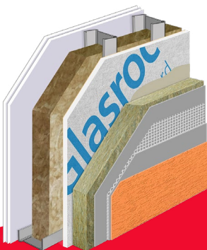
Muro exterior de hoja simple con SATE.
