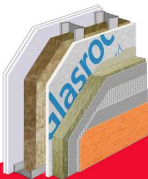
Muro exterior de hoja simple con SATE.
