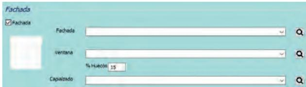
El técnico debe introducir el porcentaje de huecos de la estancia más desfavorable para que el programa realice el cálculo del aislamiento acústico total contando con la parte ciega y las ventanas. Este cálculo no es para el DB HR que en su opción simplificada establece valores para parte ciega y ventanas por separado, si no para la pre-calificación acústica de la fachada.
