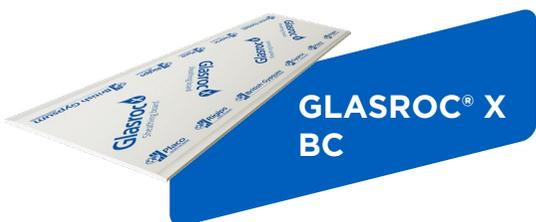
Placa de altas prestaciones, revestida y reforzada con fibra de vidrio y un tratamiento especial hidrófobo que garantiza un excelente comportamiento en ambientes de humedad muy fuerte , techos exteriores y fachadas. Con los cuatro bordes cuadrados, especialmente recomendada para utilizar con la cinta de juntas Placotherm®
