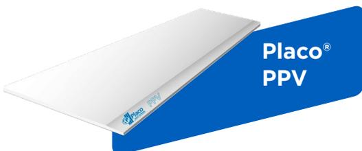
Placa de Yeso Laminado a la que se adhiere en su dorso una lámina de aluminio, obteniéndose una barrera de vapor en los trasdosados que evita las condensaciones intersticiales en los muros de fachada.
