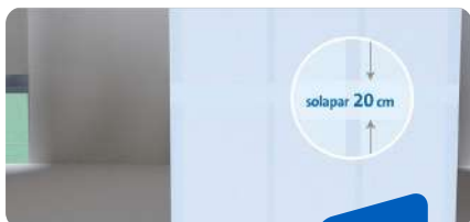
COLOCACIÓN LÁMINA IMPERMEABLE
