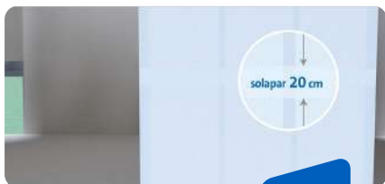
COLOCACIÓN LÁMINA IMPERMEABLE
