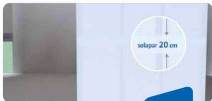
COLOCACIÓN LÁMINA IMPERMEABLE
